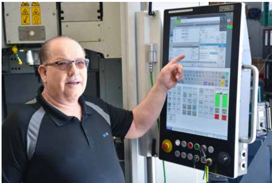
Bei der Steuerung der Fräsbearbeitungszentren setzt Franz Reisner auf die vertraute Sinumerik 840D SolutionLine von Siemens im Industrie-4.0-tauglichen Spinner Touch-Panel.
