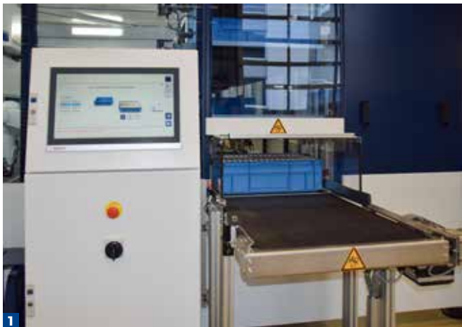
1, 2 Die Teile werden nach dem Biegevorgang sortenrein in Kleinladungsträger geschichtet. Deren auftragsbezogene Entnahme erfolgt per Abruf am Bedientermi-
