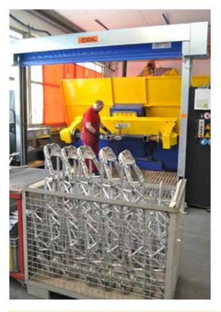
links In einer Roboter-Schweißzelle von Weldstone Advanced Automation produziert das Unternehmen Motorrad-Heckausleger aus hochfestem Aluminium.
