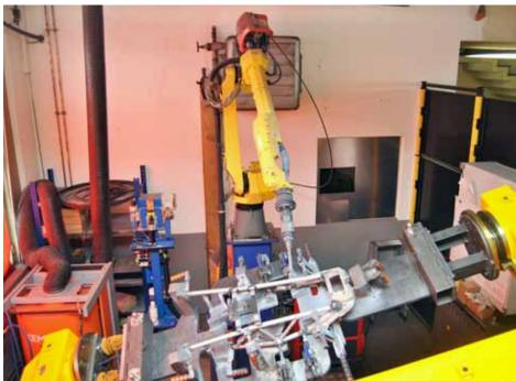
mierung rund 600 Teach-Punkte an. Fanuc-Steuerungen hatten einen zusätzlichen Startvorteil, denn sie waren im Unternehmen bereits aus Anwendungen in der mechanischen Fertigung als zuverlässig und benutzerfreundlich bekannt.
