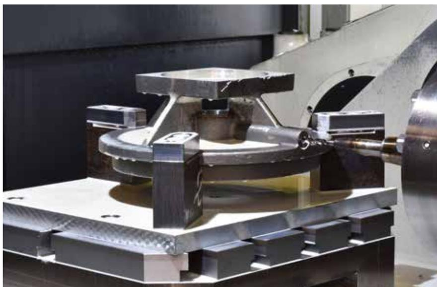
H-Tec verwendet den Einkomponenten-Kühlschmierstoff Bonderite L-MR nun **vom Sägen weg durchgängig im gesamten Unternehmen**. Verschmutzungen und Geruchsbildung nach der Gussteilebearbeitung im Mitsui Seiki Bearbeitungszentrum gehören seit der Kühlschmierstoff-Umstellung der Vergangenheit an. (Alle Bilder: x-technik)
