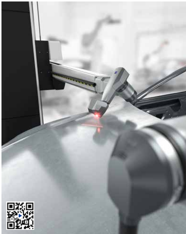
Mit Zeiss CALENO, einer Koordinatenmessmaschine in Form eines 6-Achs-Roboters und dem optischen Messsystem EagleEye bietet Zeiss die Möglichkeit, das bewährte Funktionsprinzip im vollautomatischen Betrieb zu nutzen, etwa für eine 100-Prozent-Prüfung bei Serienteilen. (Bild: Zeiss Industrial Quality Solutions)
