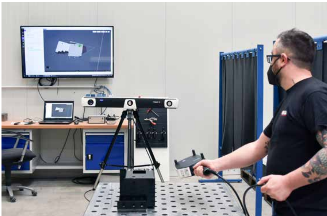
Das optische Trackingsystem verfolgt die Bewegungen von Zeiss T-SCAN im Raum. Die Scan-Software colin3D setzt die Einzel-Scans zu kompletten 3D-Modellen zusammen und nutzt diese zur Benutzerführung.
