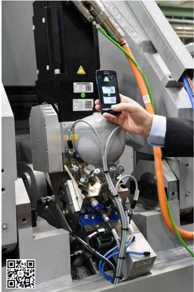
Den Drucktransmitter NAT 8252 von Trafag nutzt Salvagnini in den Biegezentren auch für die Pneumatik.
