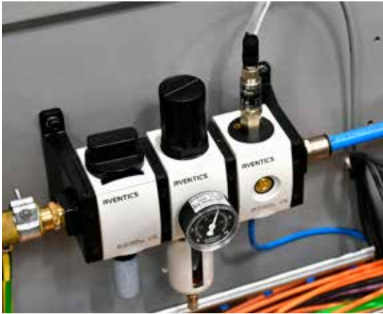
Den Drucktransmitter NAT 8252 von Trafag nutzt Salvagnini in den Biegezentren auch für die Pneumatik.
