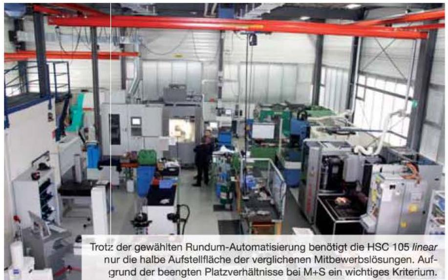
Trotz der gewählten Rundum-Automatisierung benötigt die HSC 105 *linear* nur die halbe Aufstellfläche der verglichenen Mitbewerbslösungen. Aufgrund der beengten Platzverhältnisse bei M+S ein wichtiges Kriterium.
