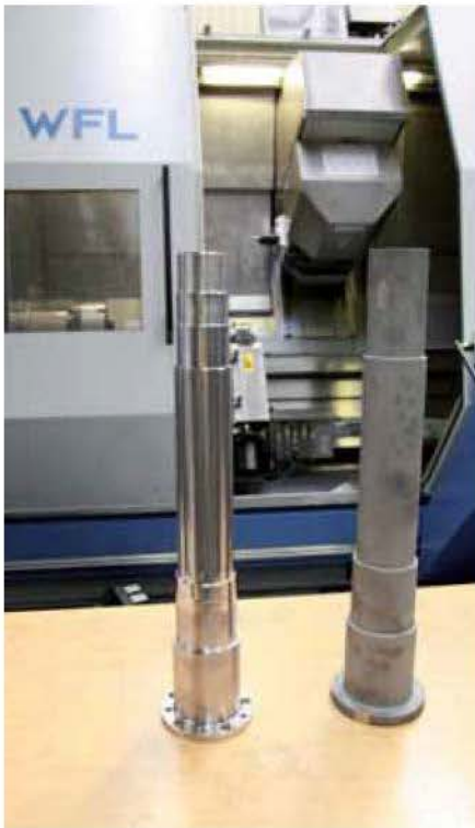
Die fertige Pumpenantriebswelle im Vergleich zum Rohteil. Die komplette Bearbeitung wird in zwei Aufspannungen auf der M40 Millturn durchgeführt.
