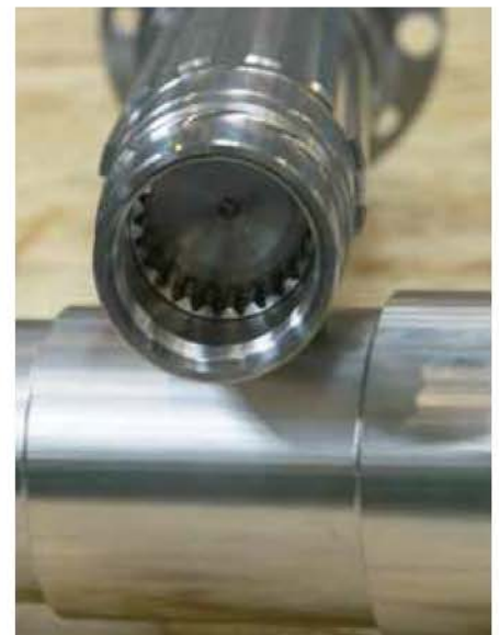
Mehr als nur ein Drehteil: Die Antriebswelle mit Innenverzahnung.
