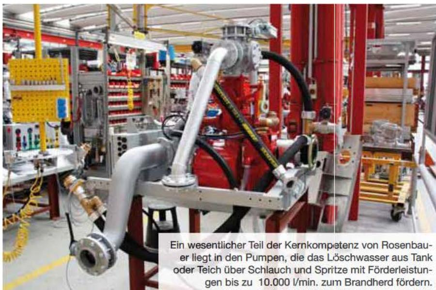
Ein wesentlicher Teil der Kernkompetenz von Rosenbauer liegt in den Pumpen, die das Löschwasser aus Tank oder Teich über Schlauch und Spritze mit Förderleistungen bis zu 10.000 l/min. zum Brandherd fördern.
