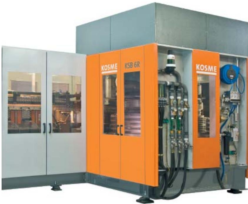
*Gesamtansicht der Maschine: Links die Heizstrecke, im orangen Teil dreht sich die Streckblasstation. Gut sichtbar: Die Medienwände für die Wasser- und Luftversorgung*
