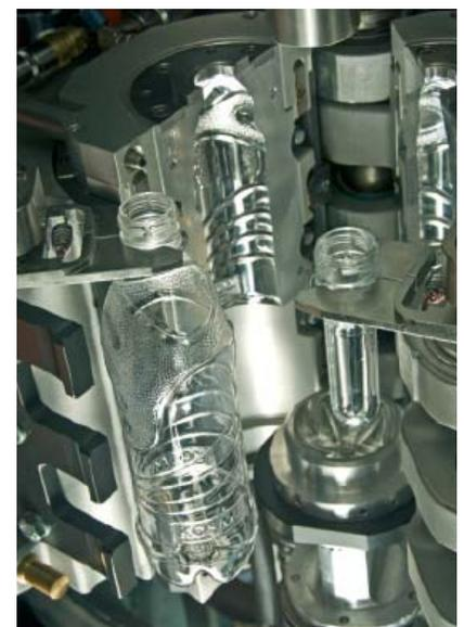
*Metamorphose: Aus dem Förmling mit angespritztem Gewinde (rechts) wird durch Strecken und Blasen in die Form (hinten) die fertige Flasche (links).*
