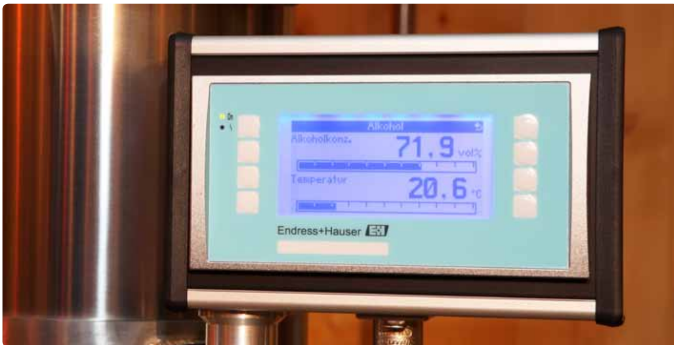
Statt mittels diskontinuierlicher Spindelablesung erfolgt die Ermittlung der aktuellen Alkoholkonzentration durch Dichtemessung mit einem Dichtemesser Liquiphant M Dichte (ganz unten) als Glasspindel-Ersatz.
