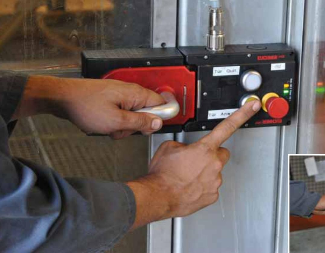
**links** Im hinteren Teil der Maschine muss für die Prozessbeobachtung zusätzlich die Sicherheitstür geöffnet werden. Das geschieht mit der Euchner MGB (Multifunctional Gate Box), die aus Zuhalte- und Griffmodul besteht. Für zusätzliche Sicherheit sorgen Tasten zur Türanwahl vor dem Öffnen und zum Quittieren nach dem Schließen.
