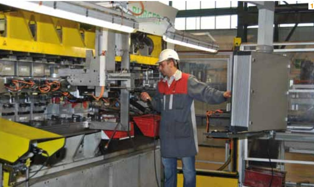
**1** Für Prozessbeobachtungen an der Bedienerseite genügt das Drücken eines Zustimmungstasters zum Deaktivieren des Lichtgitters.
