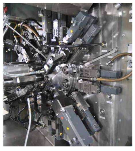
gesteuerte sowie acht kurvengesteuerte Mehrspindeldrehautomaten von Index die Hallen der Dreherei in Wien. Durch eine zentrale Kühl-/Schmiermittelversorgung und Späneabfuhr unter dem Boden sowie eine Ölnebelabsaugung herrscht in diesen eine Sauberkeit, die eher an eine Elektronikproduktion denken lässt.
