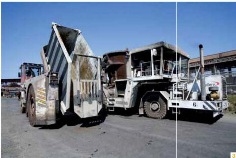
**3** Zur LogServ-Flotte für den Werksverkehr gehören Niederhubkipper (links) und Schlackentransporter mit je 110 Tonnen Gesamtgewicht in nur zwei Achsen.
