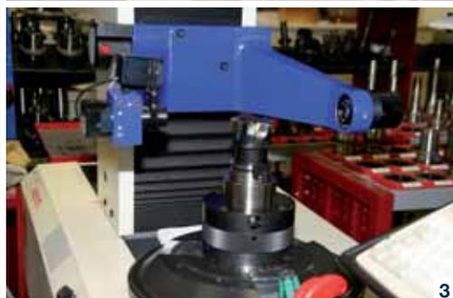
1-3 Die vollautomatische Integration des Zoller Werkzeugvoreinstellgerätes bedeutet für FILL einen wesentlichen Effizienzgewinn: Der Auftrag wird aus PRO.FILE mittels Scanner an die Messmaschine übergeben. Nach der Vermessung der Werkzeuge, werden die Korrekturdaten zum Auftrag in PRO.FILE gespeichert und anschließend gemeinsam mit dem NC-Programm von Maschinenbediener in die Steuerung geladen.
