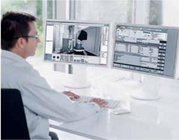
Die Überprüfung zur Kollisionsvermeidung und Bearbeitungs-optimierung erfolgt auf Basis der Werkstück-, Werkzeug- und Maschinendaten aus NX und der tatsächlichen Steuerung hauptzeitparallel in der DMG Virtual Machine.
