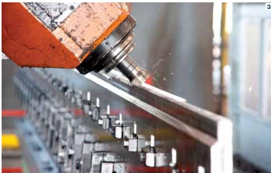
**1** Bearbeitet werden die bis zu 6,5 Meter langen Werkstücke auf einer Fahrständerfräsmaschine, ausgestattet mit sieben Magnetspannplatten von Schunk.
