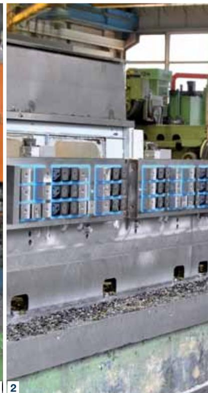
Werkstückaufspannung nachgedacht“, berichtet Stefan Winkler. „Magnetspannsystemen gegenüber waren wir allerdings anfangs skeptisch gewesen, denn das Gewicht der Teile ist beträchtlich und die Bearbeitung erfolgt mit bis zu 90 % des Spindeldrucks der starken Maschine.“
