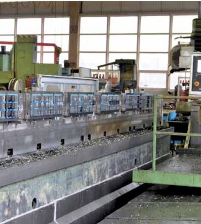
artig abwechselnd als Nord- und Südpole angeordnet sind. Sie sind voneinander magnetisch unabhängig und bestehen aus je einem Stahlkern, der von vier Seiten mit nicht umpolbaren Permanentmagneten (Neodym) umgeben ist. Unter ihnen befinden sich umpolbare Al-NiCo-Magnete. Diese Art der Werkstückspannung für die Grob- und Feinzerspanung auf Bearbeitungszentren kann dank ihrer innovativen Quadratpoltechnik einzigartig hohe Werte in Bezug auf die Haltekraft aufweisen.
