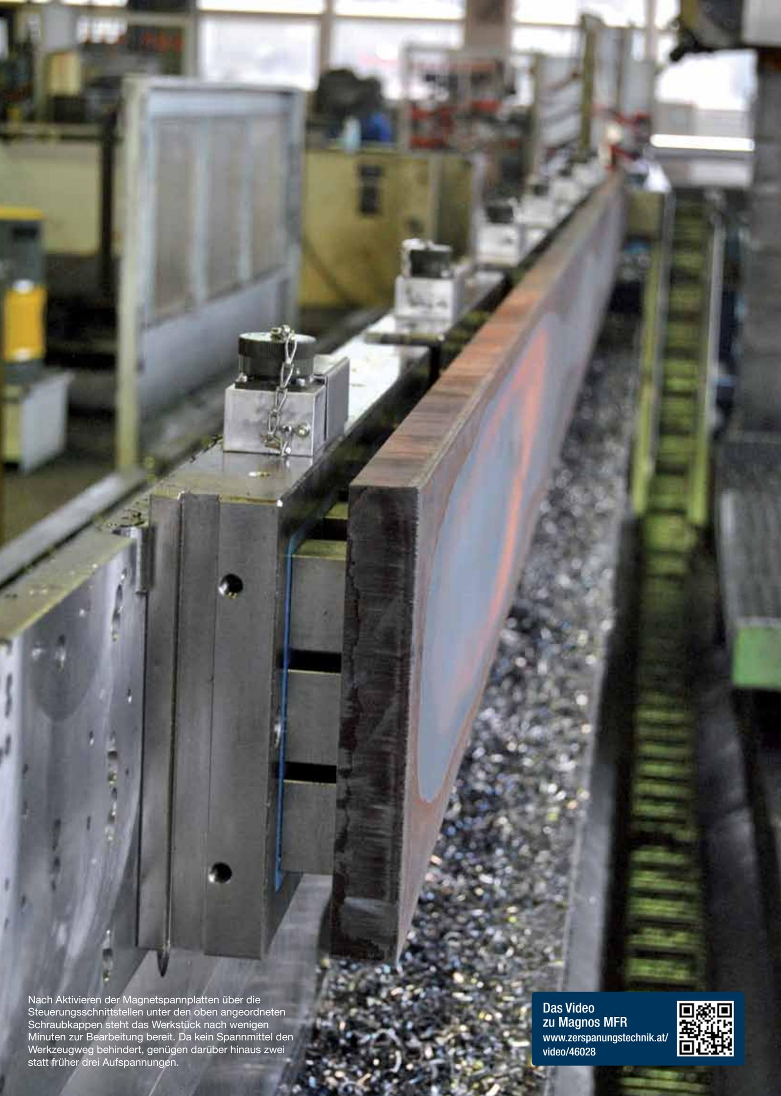
Nach Aktivieren der Magnetspannplatten über die Steuerungsschnittstellen unter den oben angeordneten Schraubkappen steht das Werkstück nach wenigen Minuten zur Bearbeitung bereit. Da kein Spannmittel den Werkzeugweg behindert, genügen darüber hinaus zwei statt früher drei Aufspannungen.
