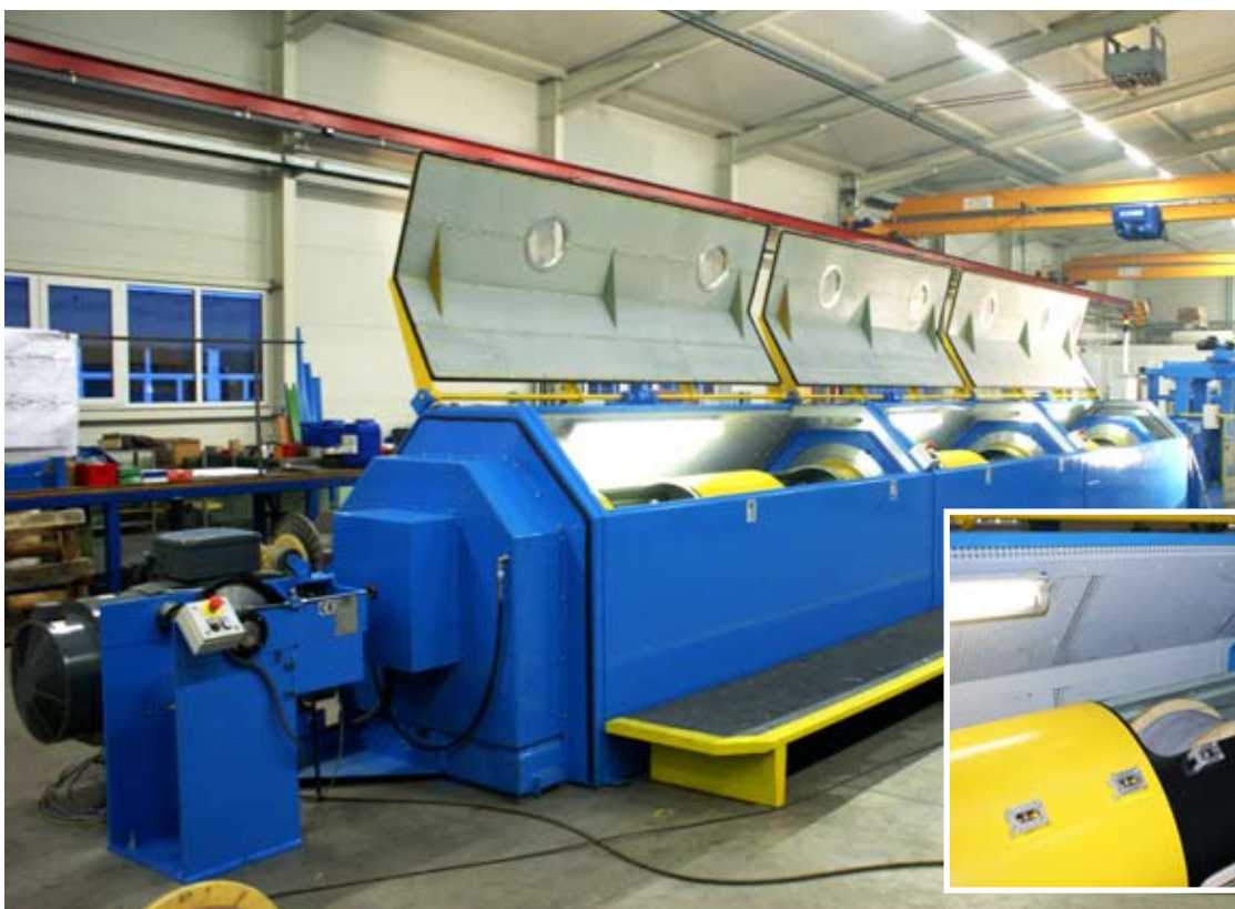
links Rohrverseilanlagen werden für die Hochgeschwindigkeitsproduktion von Kabeln mit kleinen Querschnitten und geringen Adernzahlen verwendet.
