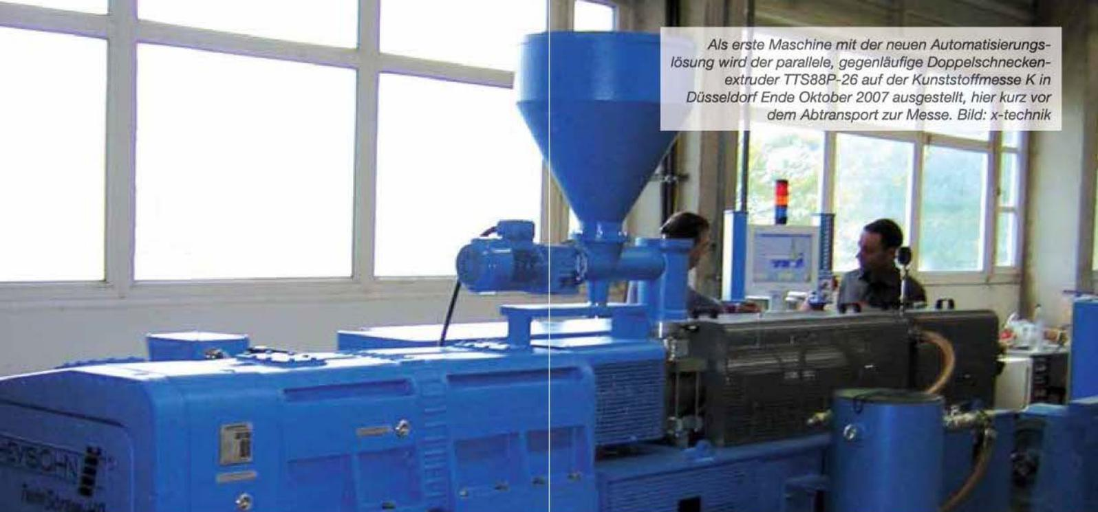
Als erste Maschine mit der neuen Automatisierungslösung wird der parallele, gegenläufige Doppelschneckenextruder TTS88P-26 auf der Kunststoffmesse K in Düsseldorf Ende Oktober 2007 ausgestellt, hier kurz vor dem Abtransport zur Messe. Bild: x-technik
