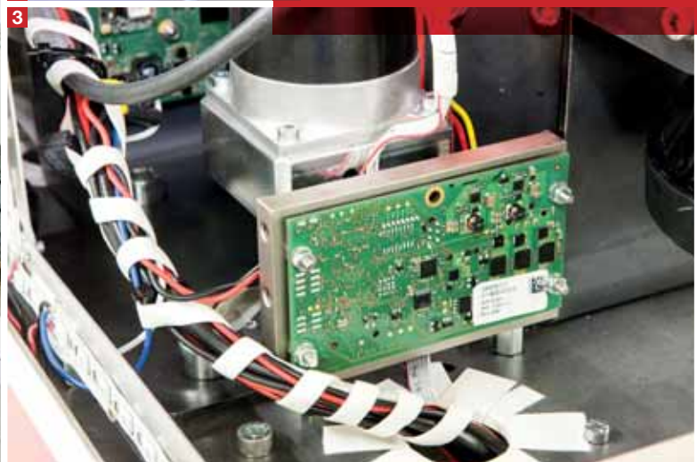
3 Die Automatisierungslösung des freifahrenden, wendigen Flur-Flitzers kommt zur Gänze von Sigmatek. Für den AGUMOS wurde nochmals am Formfaktor des S-DIAS Systems gedreht.
