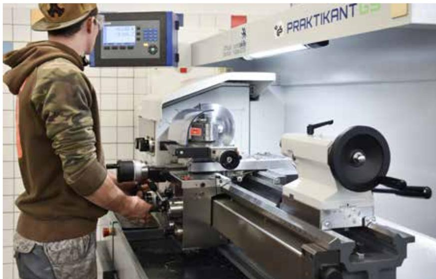
Die gute Handhabung der Weiler Praktikant GSD **mit ergonomisch angeordneten Bedienelementen** erleichtert die Ausbildung im Bereich der Zerspaltung von der Pike auf.
