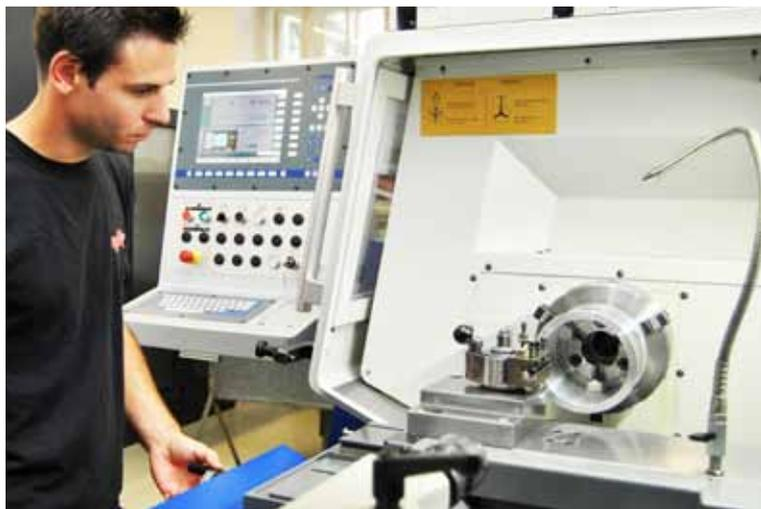
**Der Arbeitsraum der E30** weist eine gute Zugänglichkeit auf, ihre überwachten Schutzhauben sorgen für volle Sicherheit. Im Bild Daniel Arzberger: „Die Zyklussteuerung der E30 auf Basis einer Sinumerik 840 D sl ermöglicht mit praxisgerechter, einfacher Bedienung eine schnelle Anpassung an vielfältige Bearbeitungsaufgaben.“
