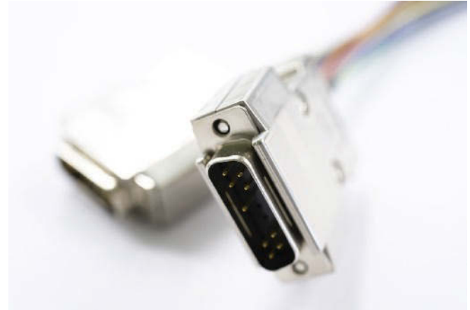
Neben den M12- und M8-Steckverbindern sind auch die bewährten D-Subminiatur-Steckverbinder weiterhin unverzichtbar. Standards der Bürowelt wie RJ45 und USB haben sich nachhaltig etabliert und sind mittlerweile auch in industrietauglichen Ausführungen erhältlich.
