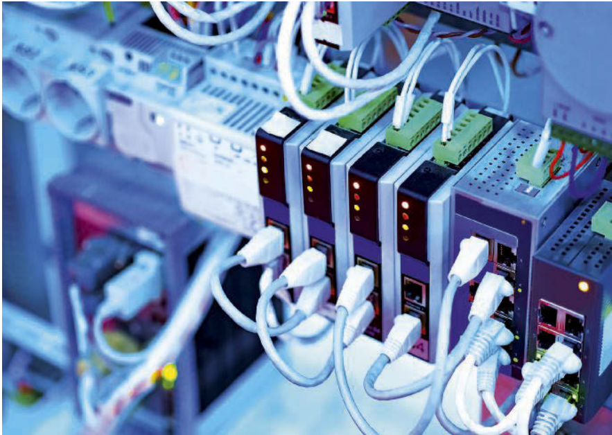
Aus der Bürowelt stammende Steckergeometrien wie RJ45 und USB haben sich auch in Industrieanwendungen etabliert und sind in entsprechenden Ausführungen erhältlich.
