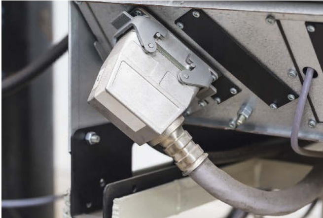
Auf der Anlagenebene verlangt das Prinzip von Industrie 4.0, austauschbare Maschinenmodule bedarfsgerecht zu verbinden. Dafür bieten sich die in zahlreichen Ausführungen erhältlichen und bewährten schweren Steckverbinder an.
