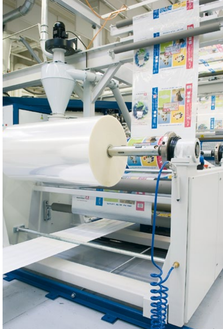
Die dehnungsfreie Zuführung von aufgerolltem Vormaterial mit gleichbleibender Zugspannung hat einen entscheidenden Einfluss auf die in der weiteren Verarbeitung innerhalb der Maschine erzeugte resultierende Produktqualität.
