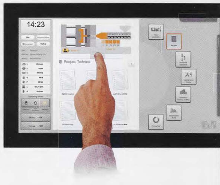
Bediener verschiebt Rezept einfach auf das Maschinenbild, um es an die Maschinensteuerung zu übergeben.
