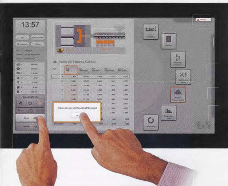
Unbeabsichtigte Fehlbedätigung ausgeschlossen: Zweihand-Bedienung quittiert kritische Schaltvorgänge.
