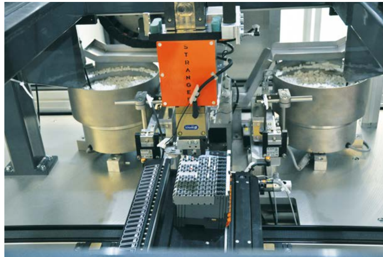
Das X20-System kann als Komplettsystem mit Gewährleistung bezogen und komfortabel in einem Stück auf die Hutschiene gesetzt werden. Das erhöht die Prozesssicherheit.
