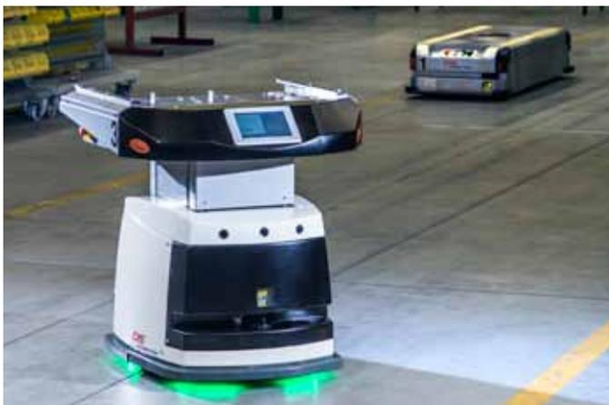
Das cyber-physikalische Transportfahrzeug SALLY navigiert per SLAM-Technologie und nutzt Simultaneous Localizing und Mapping zur Überprüfung des Fahrkurses anhand natürlicher Umgebungsmerkmale.
