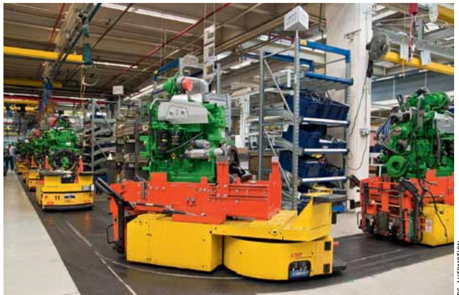
Fahrerlose Transportsysteme von DS Automotion waren bereits 1984 in der Automobilindustrie im Einsatz.
