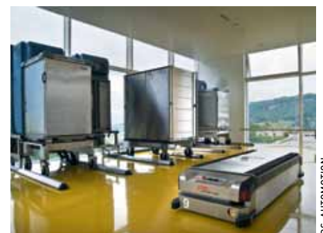
Seit 1997 erledigen FTS von DS Automotion in zahlreichen Krankenhäusern die Ver- und Entsorgung von Stationen und Operationssälen.
