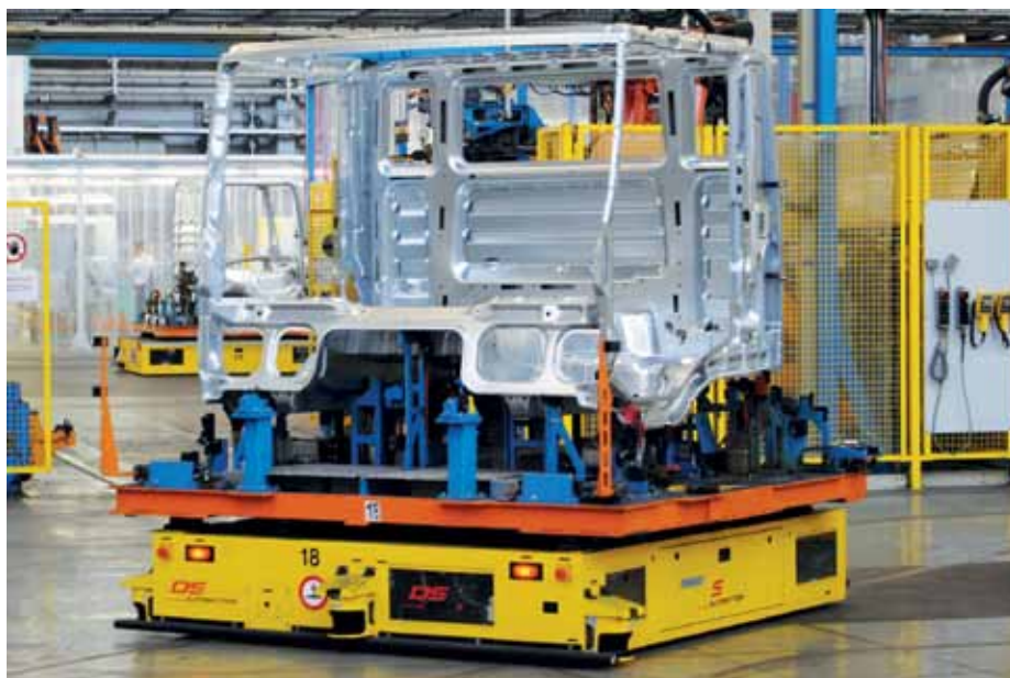
Spurgeführte FTS von DS Automotion ermöglichen eine agile Montage nach den Grundsätzen von Industrie 4.0. Ihre Steuerung erfolgt mit der FTS-Leitsteuerung „DS Navios Trackguide“.
