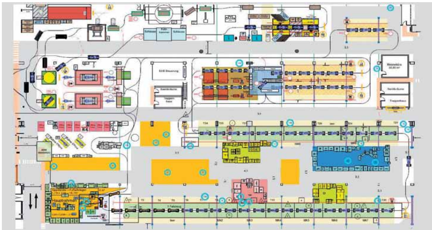
Die Logik der Fahrbewegungen spurgeführter FTS folgt vorwiegend dem Fließ-/Taktschema der Produktionsarbeitsplätze. Ihre Leitsteuerung basiert auf ähnlicher SPS-Technik wie die Automatisierung der Produktionsanlagen, in die sie eingebettet sind.
