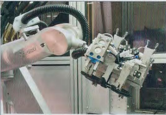
Handling per Roboter an einer Spritzgießmaschine, integriert in eine Automatisierungslösung: Open Safety unterstützt den Aufbau solcher Maschinenkonzepte durch die virtuelle Verdrahtung über das Netzwerk
