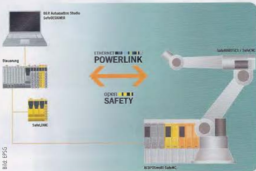
Bild 2: Mit Powerlink lassen sich Roboter vollständig in die Automatisierung integrieren, ebenso lassen sich mittels openSafety Sicherheitsfunktionen umsetzen.
