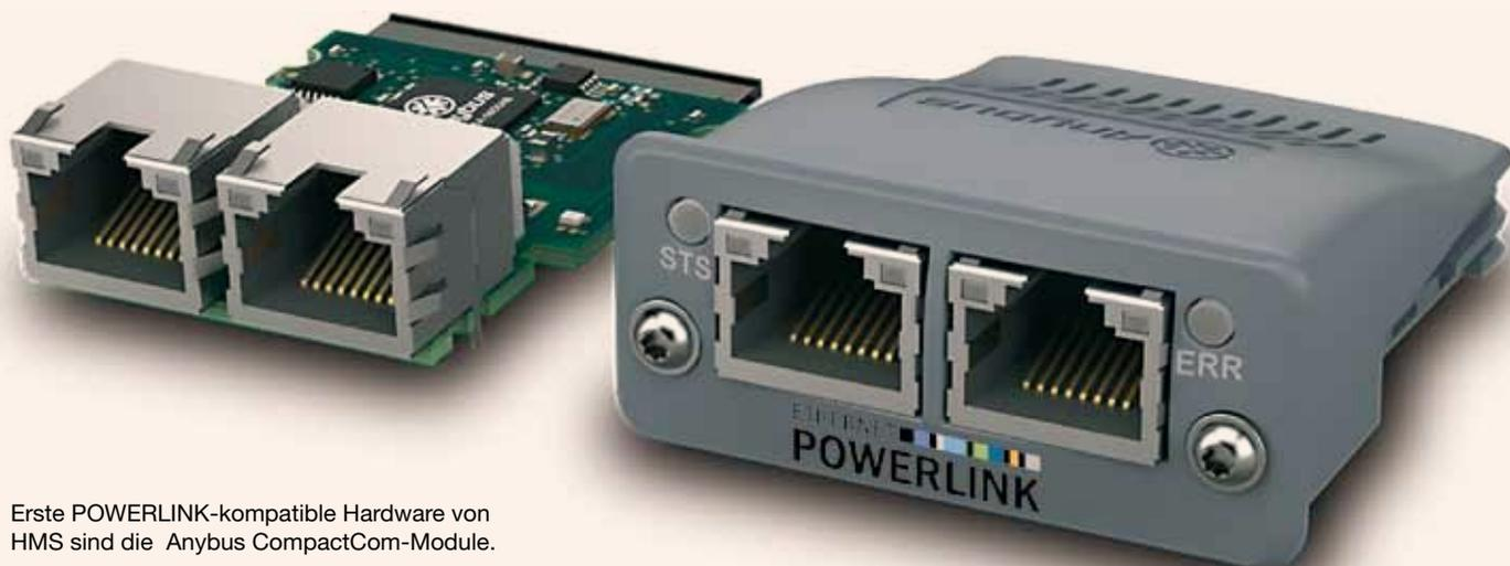
Erste POWERLINK-kompatible Hardware von HMS sind die Anybus CompactCom-Module.
