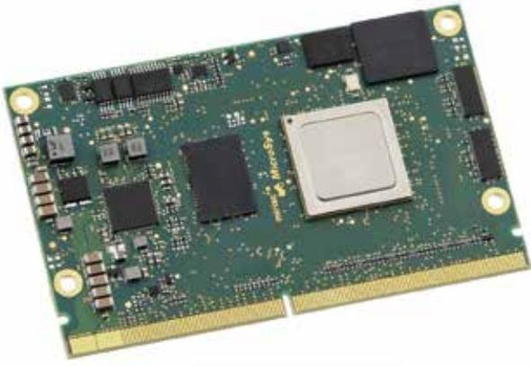
Die einfach zu integrierenden System-on-Module (SoM) auf Basis moderner Multicore-Prozessoren von NXP eignen sich durch deren Architektur und ihr zertifizierungsfreundliches Design bestens für die Entwicklung sicherer Steuerungssysteme.
