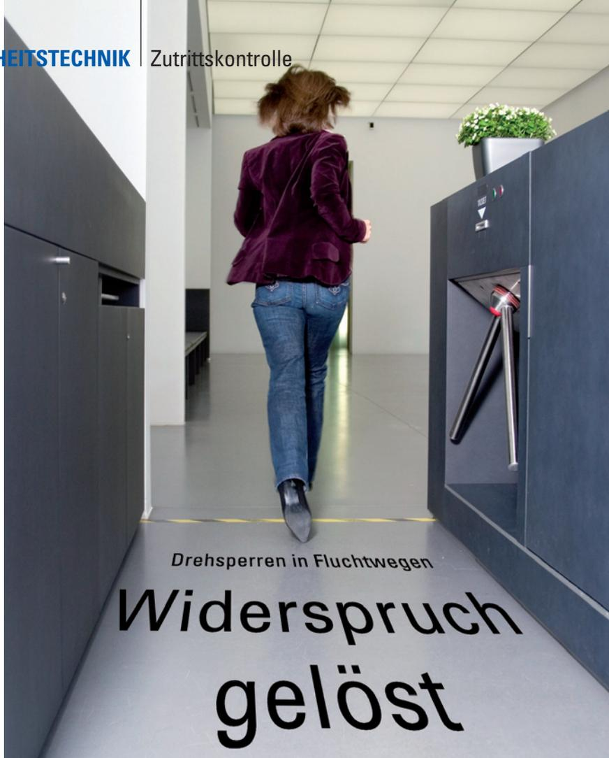
*In der Offen-Stellung ist die Durchgangsspur bei asymmetrischen Zwei-Arm-Drehsperrern völlig frei von herabhängenden oder in den Fußraum ragenden Holmen.
