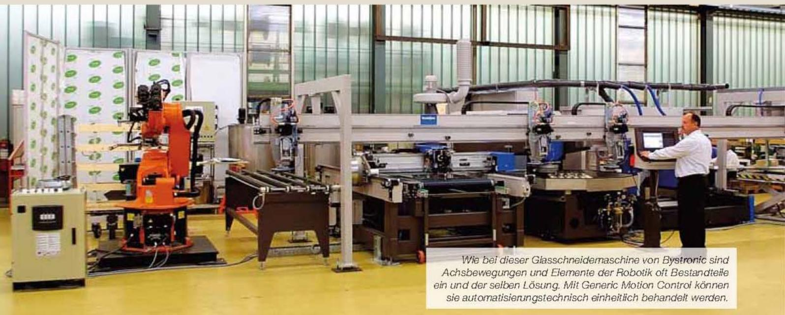
*Wie bei dieser Glasschneidemaschine von Bystronic sind Achsbewegungen und Elemente der Robotik oft Bestandteile ein und der selben Lösung. Mit Generic Motion Control können sie automatisierungstechnisch einheitlich behandelt werden.*
