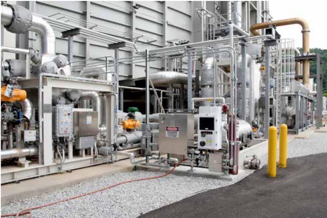
Ein Raman-Analysator Rxn5 von Endress+Hauser bestimmt inline Zusammensetzung und Energiegehalt des Gasgemisches und **hilft, eine für das Verbrennungssystem schädliche Überdosierung zu verhindern.**
