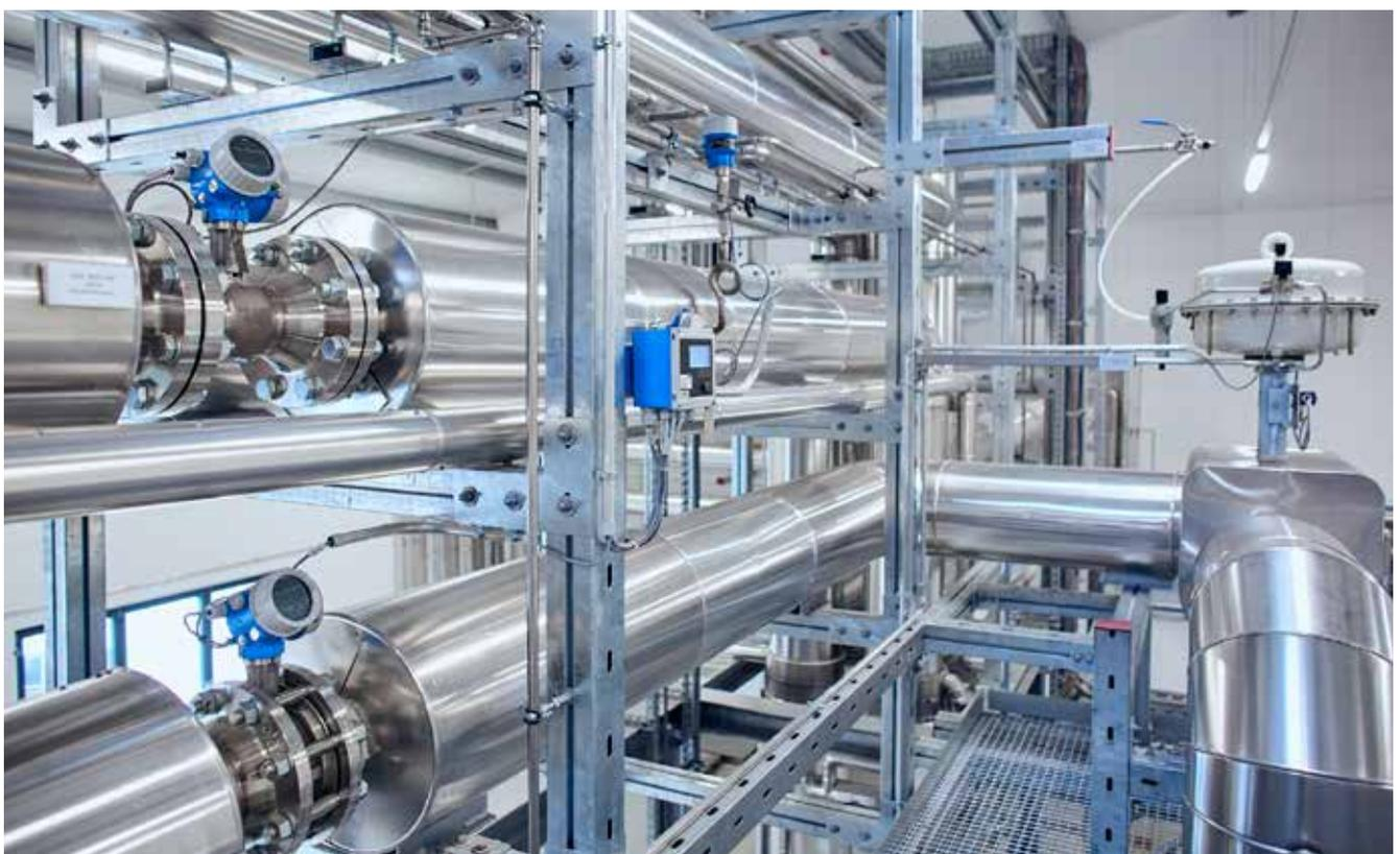
Mit der patentierten differenziellen Absorptionsspektroskopie misst der TDLAS-Analysator **geringste Verunreinigungen und Restfeuchte im Wasserstoff**. QF-Analysatoren (Quenched Fluorescence) messen den Sauerstoffgehalt zuverlässig und exakt.
