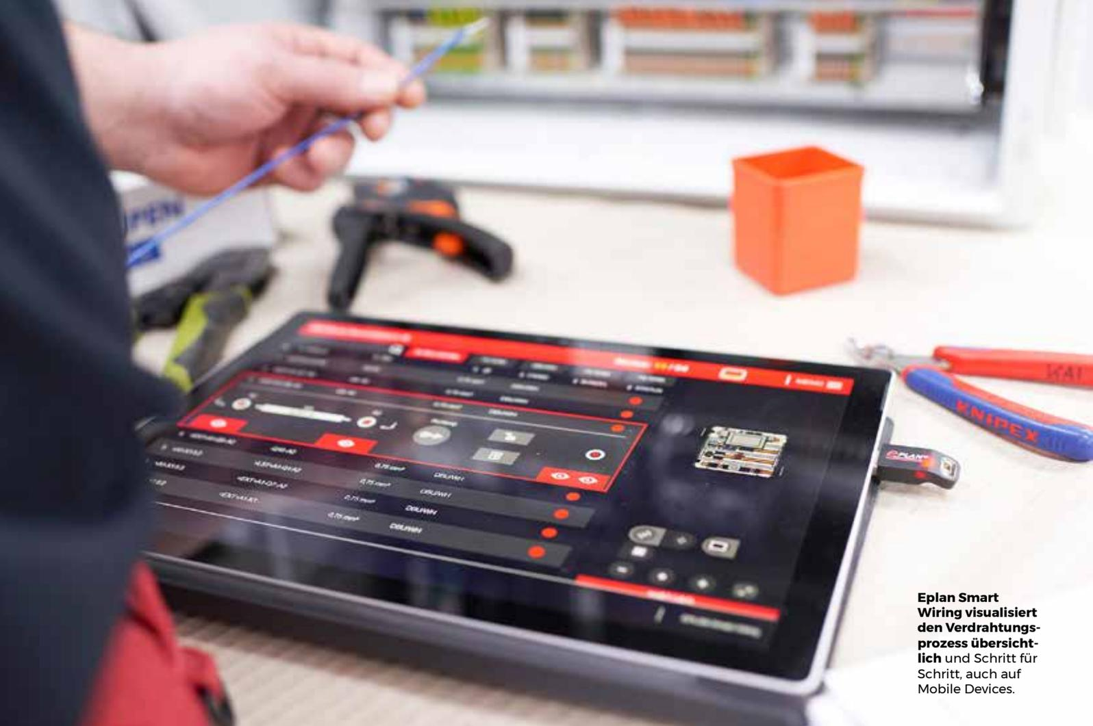
**Eplan Smart Wiring visualisiert den Verdrahtungsprozess übersichtlich und Schritt für Schritt, auch auf Mobile Devices.**
