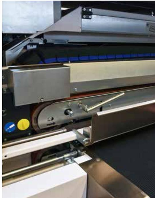
**links** Die Baureihe SBM-XS – hier im Einsatz bei Lissmac – ist speziell für Kleinteile ausgelegt. Vakuumförderbänder transportieren die aufgelegten Teile durch die Maschine, eine innovative Wendevorrichtung ermöglicht die **beidseitige Bearbeitung der Schnittkanten in einem Arbeitsgang.**
