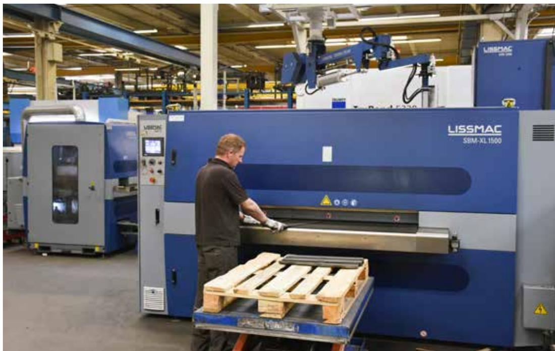
Die Lissmac SBM-XL 1500 S2B2 zur Oxidschichtentfernung und beidseitigen Kantenverrundung im Einsatz in der **Blechteilproduktion bei Lissmac.**
