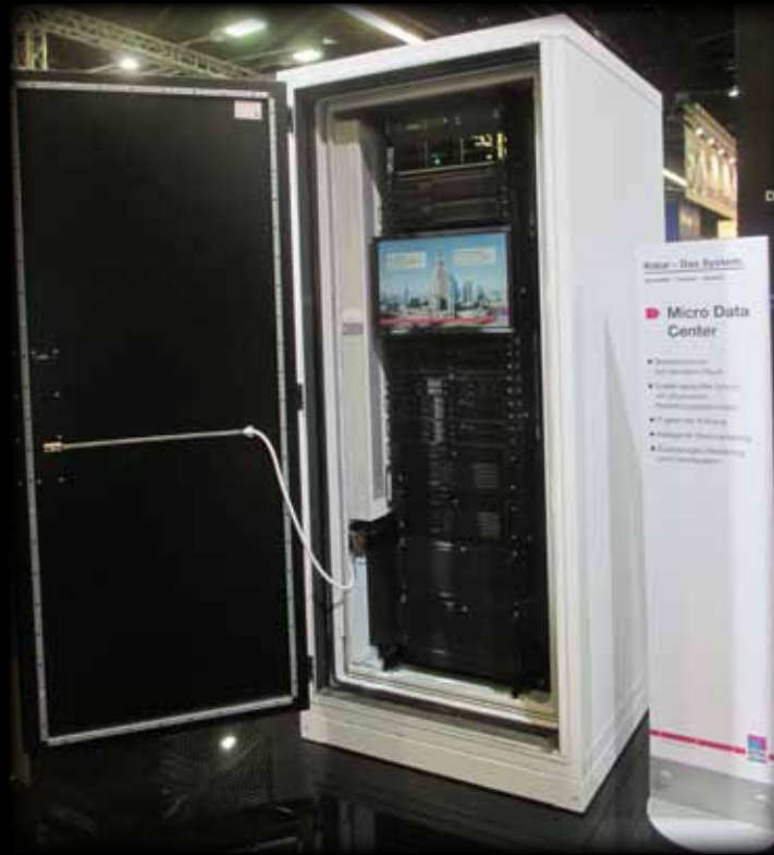
Mit dem Micro Data Center (hier auf der SPS IPC Drives 2016) bietet Rittal eine Lösung zum Betrieb von IT-Anwendungen auch in der rauen Umgebung von Produktionshallen oder Prozessanlagen an.
