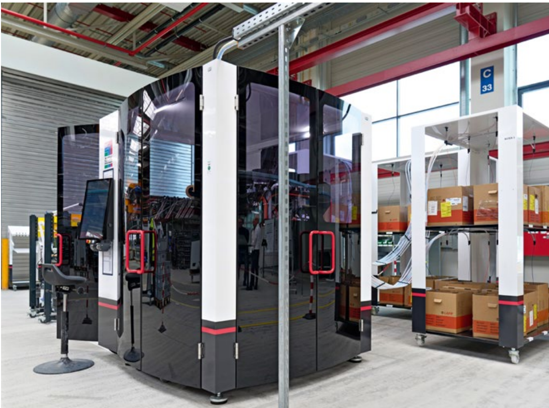
Das Wire Terminal WT C von Rittal konfektioniert Drähte mit Querschnitten von 0,5 bis zu 6 mm 2 vollautomatisch , einschließlich Abisolieren in Voll- und Teilabzug, Crimpen und Beschriftung.
