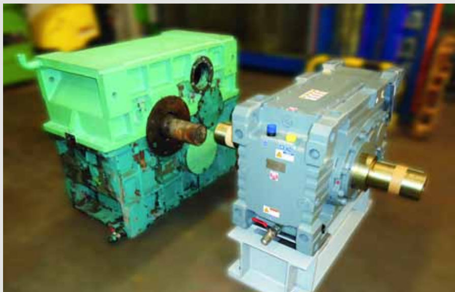
Das Effizienz-steigernde Retrofit älterer Antriebe bietet SEW-Eurodrive unter der Bezeichnung Remanufacturing auch zum Fixpreis an. Mit Drop-in Einheiten lassen sich verschlissene Getriebe von anderen Herstellern ersetzen.
