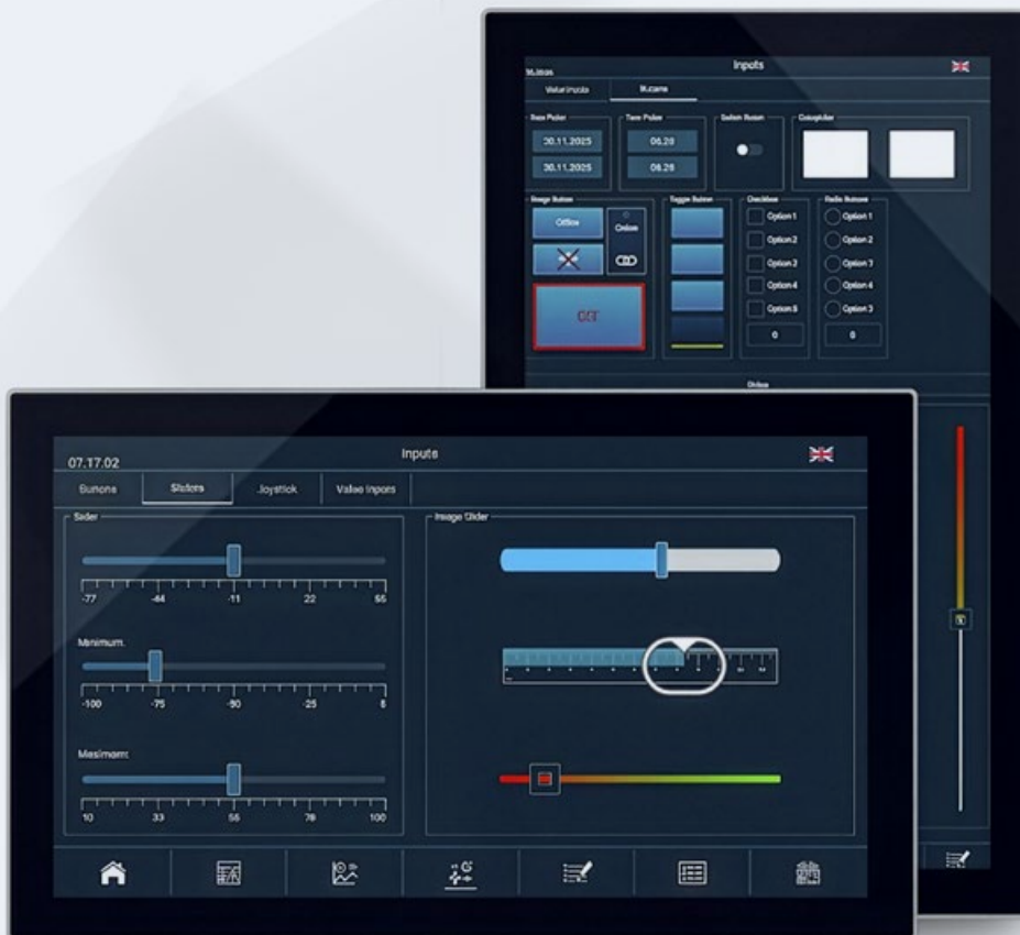
Die xx20-Panels im Format 16:9 mit Glas-Multitouch, mit schlankem Aluminiumrahmen und frontseitig Schutzart IP65 machen im Hoch- und Querformat eine gute Figur.
