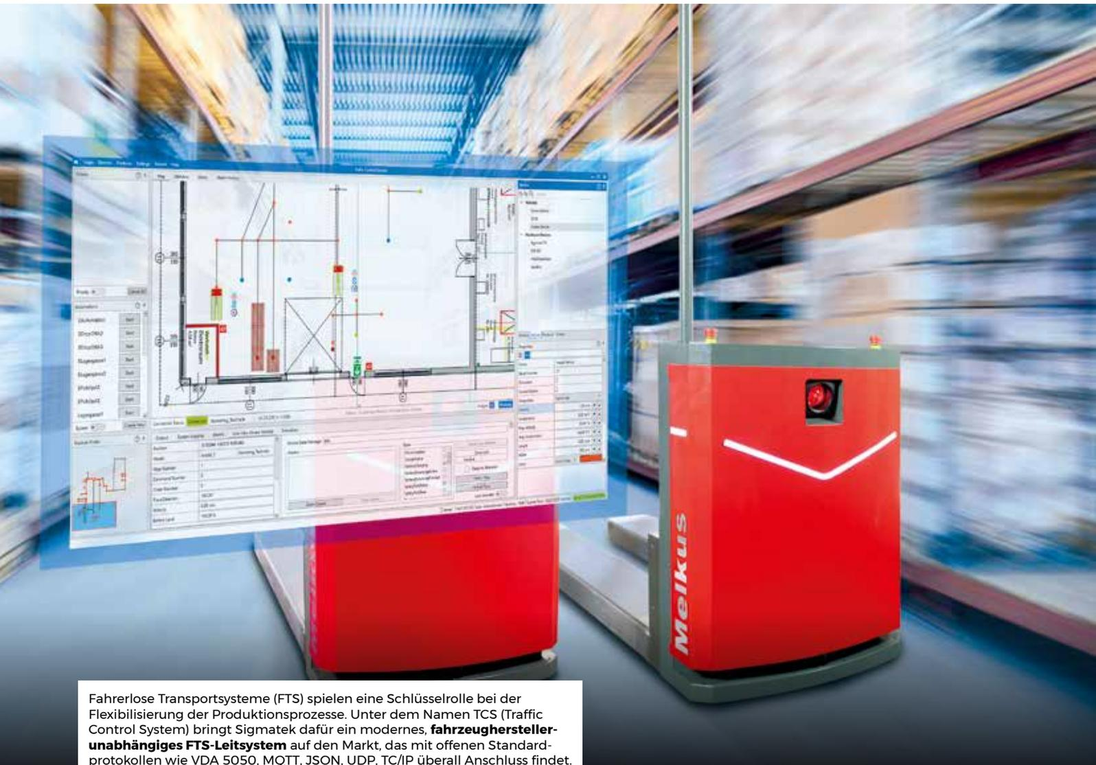
Fahrerlose Transportsysteme (FTS) spielen eine Schlüsselrolle bei der Flexibilisierung der Produktionsprozesse. Unter dem Namen TCS (Traffic Control System) bringt Sigmatek dafür ein modernes, **fahrzeughersteller-unabhängiges FTS-Leitsystem** auf den Markt, das mit offenen Standardprotokollen wie VDA 5050, MQTT, JSON, UDP, TC/IP überall Anschluss findet.
