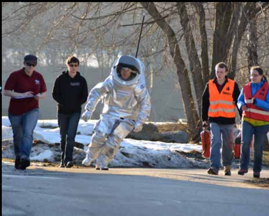
Die geringere Schwerkraft auf dem Mars wird simuliert, indem der Anzug auf dasselbe Ver- hältnis zwischen Gewicht und Betätigungskraft wie auf unserem Nachbarplaneten getrimmt wird. Sichtbar wird das in Kurven, wo der Astronaut bei gleicher Geschwindigkeit mehr Querbeschleunigung erfährt und entsprechend gegensteuern muss.
