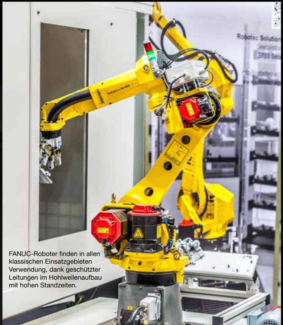
FANUC-Roboter finden in allen klassischen Einsatzgebieten Verwendung, dank geschützter Leitungen im Hohlwellenaufbau mit hohen Standzeiten.
