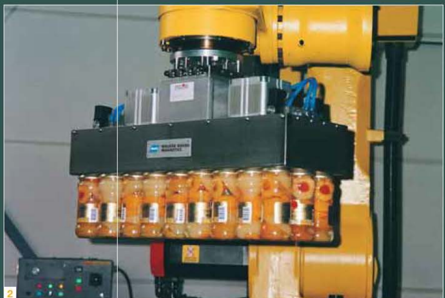
2 Roboterhandling mit reinen Permanentmagneten in der Lebensmittelindustrie.
