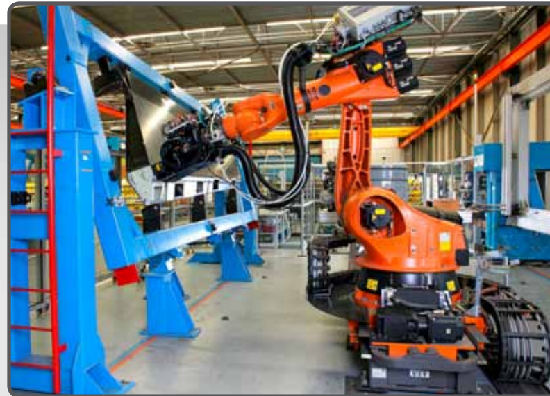
oben Bei der Bearbeitung hochpräziser Bauteile kommt es auf exaktes Arbeiten und höchste Qualität an. Simulationsbasierte offline-Programmierung optimiert die Verfahrswege. (Bild: Copyright KUKA Roboter GmbH)
