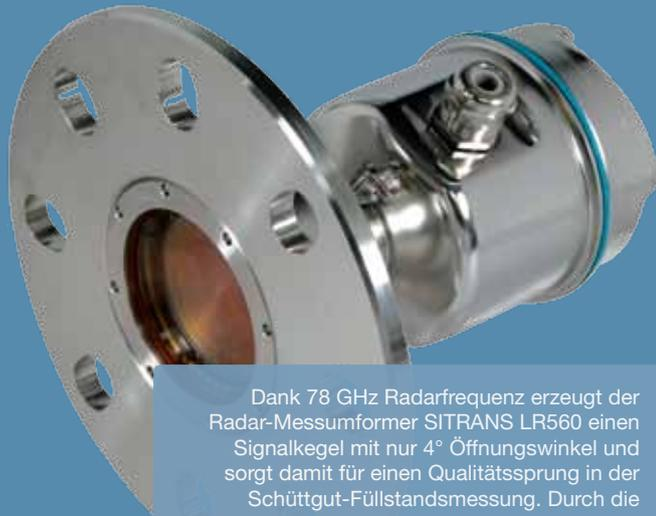
Dank 78 GHz Radarfrequenz erzeugt der Radar-Messumformer SITRANS LR560 einen Signalkegel mit nur 4° Öffnungswinkel und sorgt damit für einen Qualitätssprung in der Schüttgut-Füllstandsmessung. Durch die Verwendung einer Linsenantenne kann das Horn wegfallen. So entsteht eine glatte Oberfläche mit wenig Möglichkeiten für Verschmutzung.
