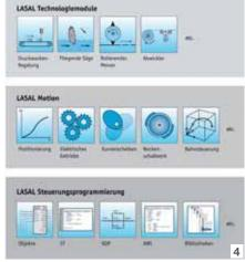
3 Das objektorientierte Tool LASAL sorgt für eine sehr hohe Modularität der Motion Control Bausteine. Durch beliebiges Kombinieren können unterschiedlichste applikationstechnische Anwendungen sehr einfach realisiert werden. Dabei ist die Bewegungsansteuerung von der eingesetzten Hardware unabhängig.
