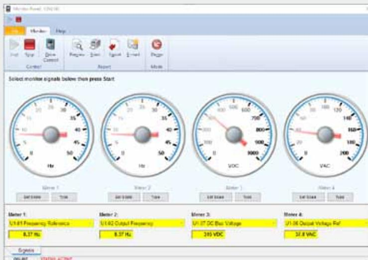
Das Software-Tool DriveWizard vereint Fehlersuche, Wartungsmöglichkeiten, Backups und Trendanalysen bis hin zu einem Oszilloskop unter einer Oberfläche. Auch eine Anbindung an die Cloud ist möglich.
