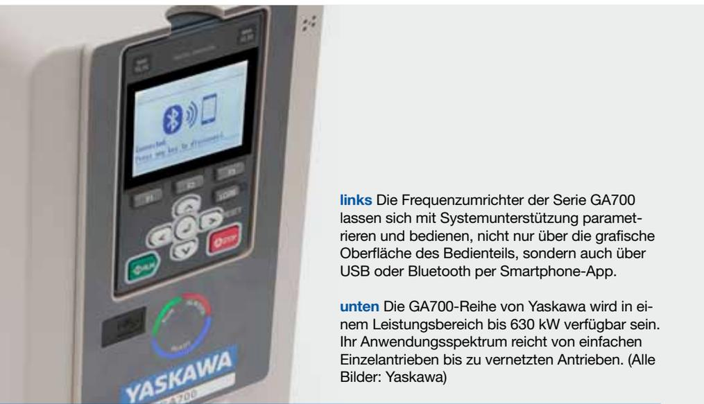
**links** Die Frequenzumrichter der Serie GA700 lassen sich mit Systemunterstützung parametrieren und bedienen, nicht nur über die grafische Oberfläche des Bedienteils, sondern auch über USB oder Bluetooth per Smartphone-App.
